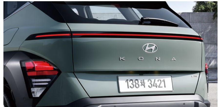
스포일러 통합형 보조제동등, 수평형 LED 테일램프, LED 제동등, LED 방향지시등
