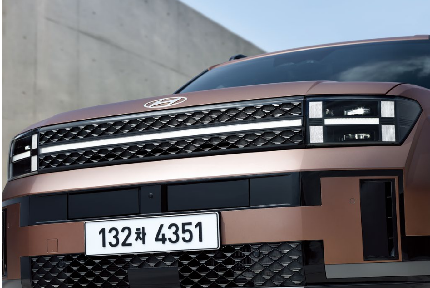
수평형 LED 램프(포지셔닝램프) & Full LED 헤드램프(프로젝션 타입)
